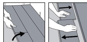
Separe toda la fila levantándola con delicadeza en un ángulo. Para separar los tablones, colóquelos en el suelo y sepárelos. Si los tablones no se separan fácilmente, puede levantarlos ligeramente a unos 5 grados cuando los esté separando.
